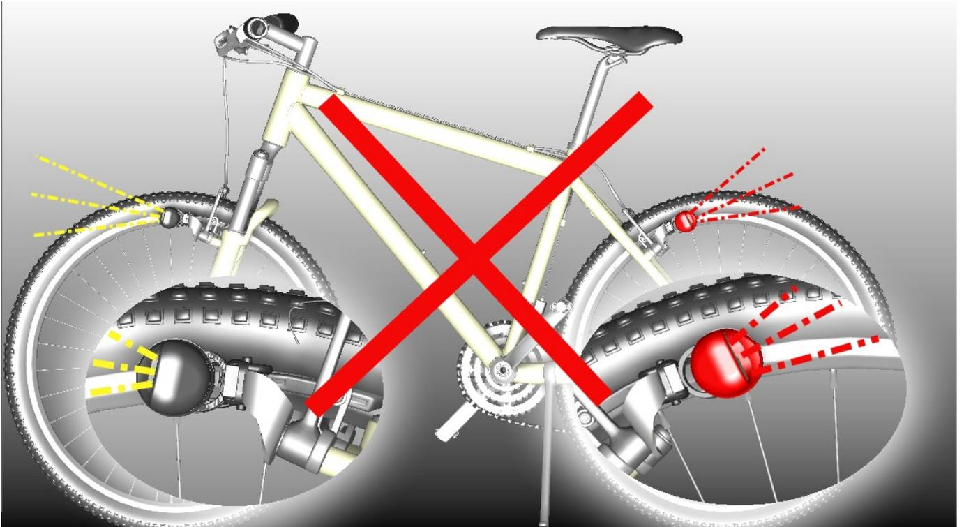
Im obigen Bild ist der Frontscheinwerfer und auch der Rücklicht-Scheinwerfer über jeweils zu weit nach oben ausgerichtet. Dieses erzeugt eine starke Blendwirkung und verschlechtert auch die Ausleuchtung des eigenen Sichtfeldes.
